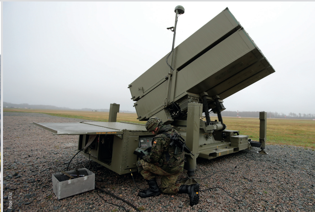
El jefe de uno de los dos lanzadores del sistema de corto alcance NASAMS desplegados en Letonia introduce las coordenadas del disparo.
