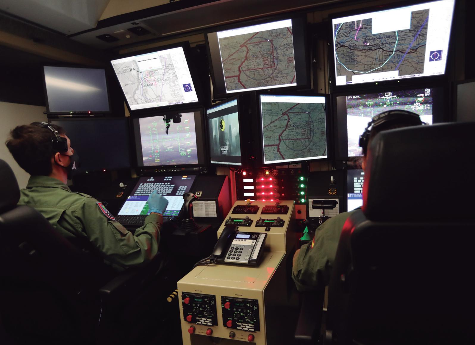
Interior de la Estación de Control en Tierra, la cabina de vuelo del NR.05, en la que trabajan juntos el piloto y el operador de sensores —izquierda y derecha, respectivamente— gestionando un gran flujo de información presentada en sus pantallas.
